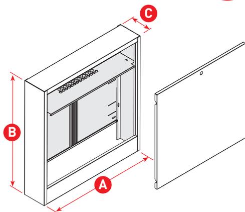
Szafka natynkowa do montażu rozdzielaczy obwodów grzewczych. Szafka przeznaczona jest do osłonięcia rozdzielacza, grupy mieszającej oraz listwy sterującej przed uszkodzeniami mechanicznymi. Zabezpiecza przewody przed zerwaniem, przecięciem oraz wyrwaniem. Szafka posiada walory, które umożliwiają dopasowanie do różnego rodzaju wnętrza.
